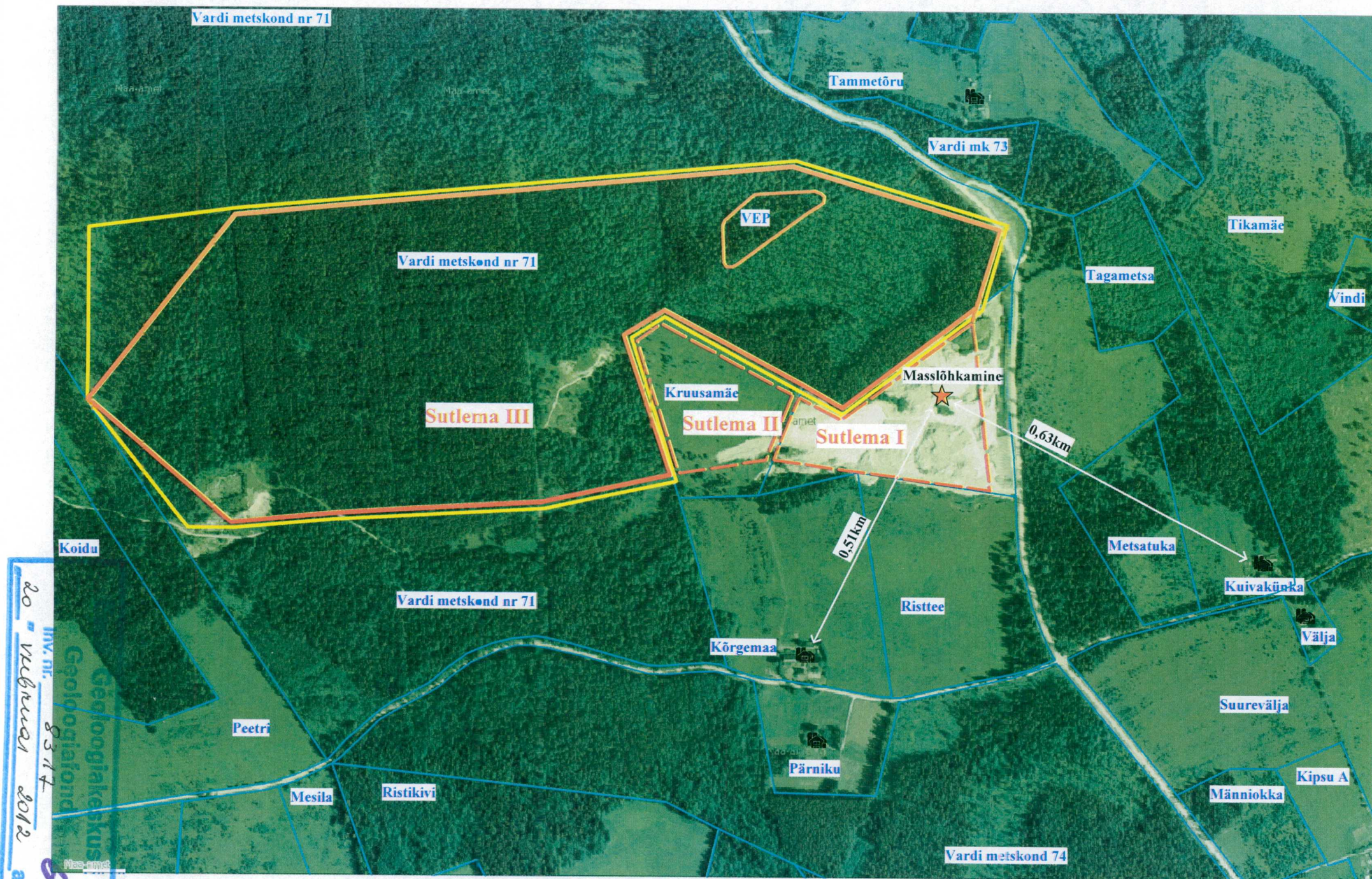
Joonis 7. Masslõhkamise seismiliste maavõngete mõõtmine Kuivaküla ja Kõrgemaa hoonete vundamentidel. Mõõtis Aragon Consulting OÜ 22.septembril ja 14. oktoobril 2009. a. Mõõtmistulemuste protokollid on esitatud lisas 7.
