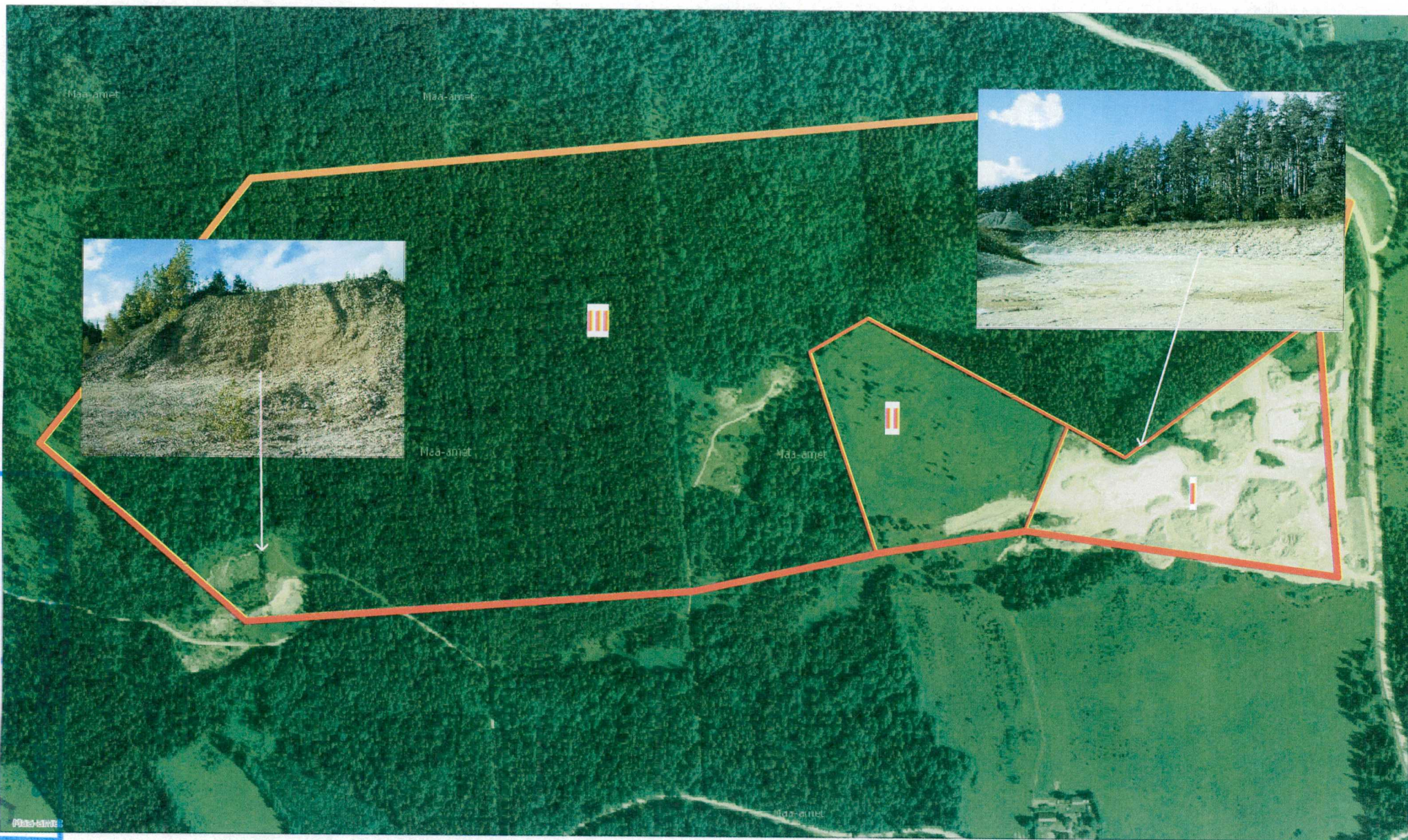
Joonis 5. Sutlema lubjakivimaardla piires moodustab pinnakatte rähkne saviliivmoreen, mida on aastate jooksul kaevandatud täitekruusana ja kasutatud teede ehitamiseks. Vasakpoolsel fotol on näha vana täitekruusa karjääri 3-4 m kõrgune nõlv, karjääri põhjas paljandub lubjakivi. Parempoolsel fotol on Sutlema I lubjakivikarjääri mäeeraldisel täitekruusa kihti näha vaid taamal, esiplaanil on kruus kaevandatud ja paljandub lubjakivipõrand. Alus: aerofoto Maa-ameti kaardirakendusest. I- Sutlema I lubjakivikarjääri mäeeraldis; II - Sutlema II lubjakivikarjääri mäeeraldis; III - taotletav Sutlema III lubjakivikarjääri mäeeraldis.
