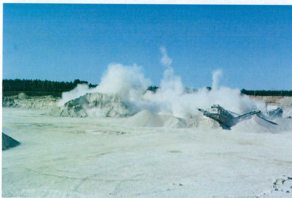
Joonis 9. Lõhkamine lubjakivikarjääris (Sopimetsa karjäär Jõgevamaal). Sarivõtte 2. (ülal) ja 15. (all) kaader. Lõhatud nõlva kõrgus on 5–6 m. Kivitükkide lennukõrgus paarkümmend meetrit, lennukaugus alla 50 m. Tolmu ja heitgaaside vertikaalne levik ca 20–25 m. Tolm hajus mõne minuti jooksul ja ei väljunud karjääri alalt.
